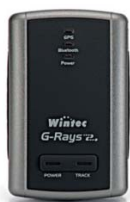
รูปที่ 4 อุปกรณ์รับสัญญาณ GPS พร้อมฟังก์ชัน data logger
